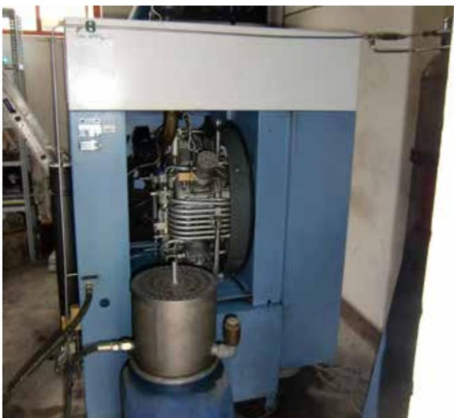
überholt. Einige Bauteile waren nicht mehr in Ordnung, sie wurden ausgetauscht. Zum Schutz des Prüfgerätes wurde die Luftdruckleitung etwas modifiziert, sodass die Prüfluft jetzt direkt aus der Pufferflasche kommt, ohne dass der Kompressor dafür gestartet werden muss.
