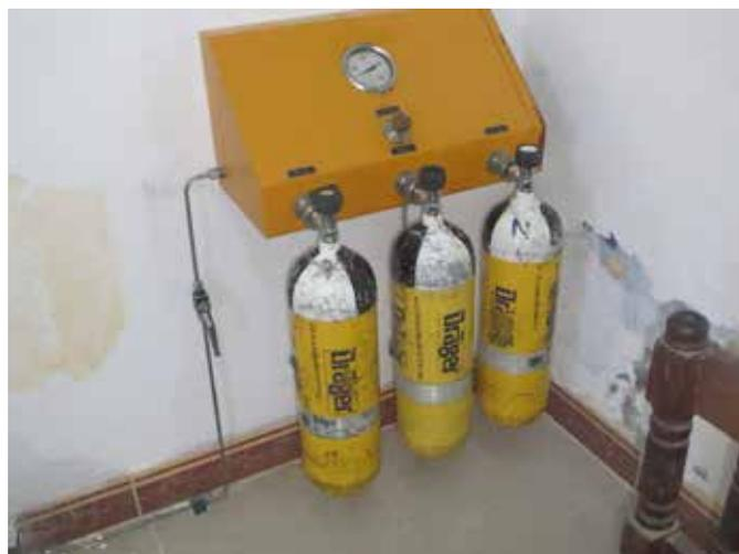
sat Filters stand einer Befüllung der Atemluftflaschen nichts mehr im Wege.
